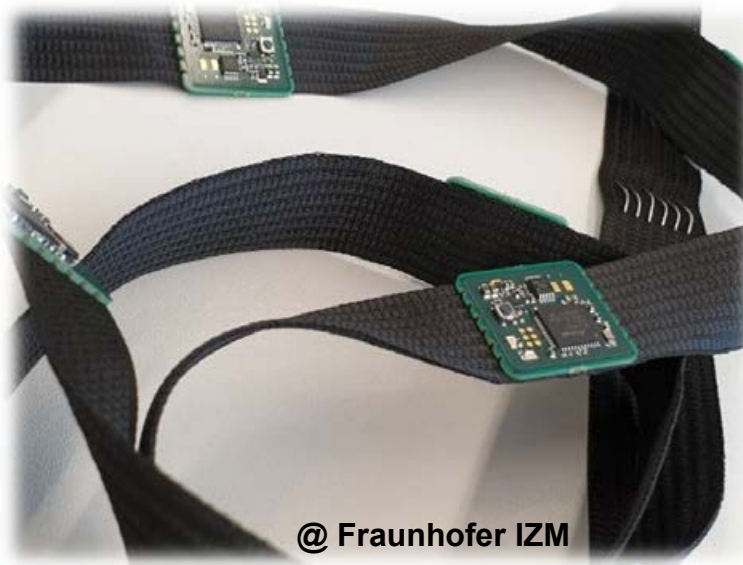
Hochrobuster textiler Bus mit isolierten High- end Leitern für Daten- und Energietransfer und gebondete Sensormodule
