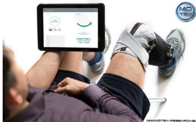
Kniebandage mit integrierter Kniewinkel- messung für Reha - Anwen- dungen
