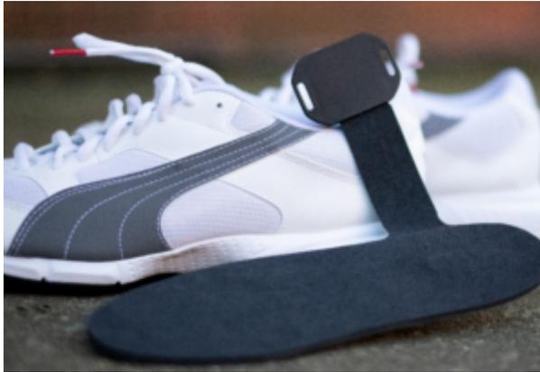
**Schuheinlage mit Drucksensoren**
