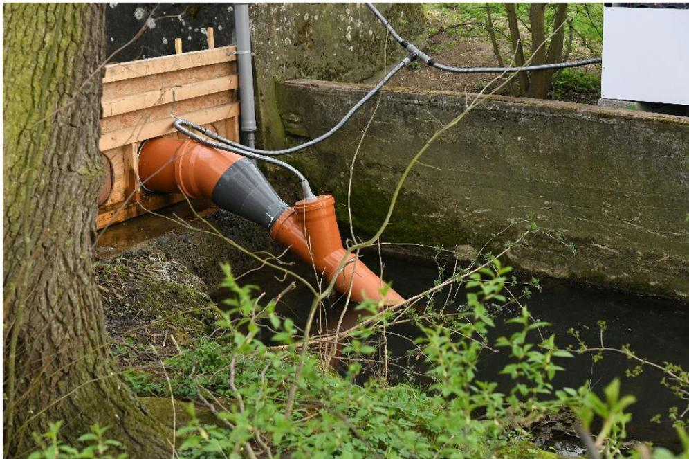
Installation des Venturirohrs im Kanal der Storchenmühle und flexible Druckleitung zum Generator-Teststand.
