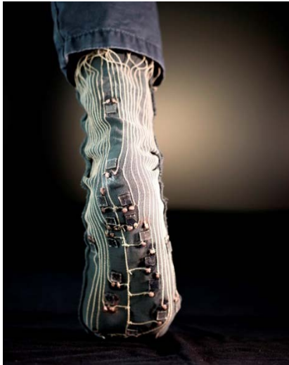
Gesundheitliche Prophylaxe: Elastomersensoren zu einem Druckmessstrumpf verarbeitet
